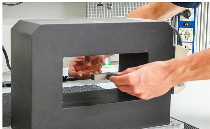
DEMAGNETIZZAZIONE DI UN OGGETTO DI TEST FERROMAGNETICO
