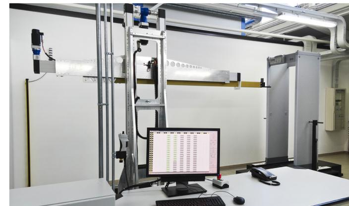
PROVA DI CAPACITÀ DI RILEVAZIONE CON POSIZIONATORE AUTOMATICO
