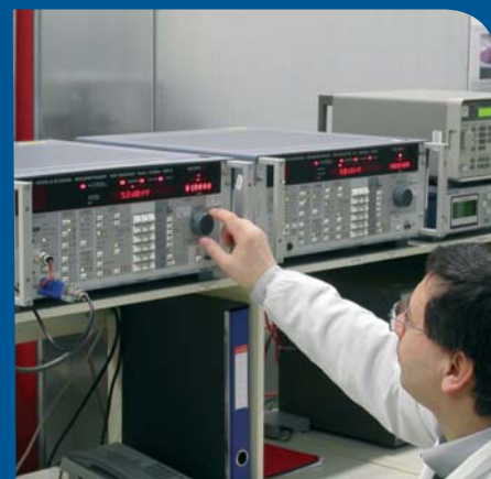
STRUMENTAZIONE PER LA MISURA DI DISTURBI CONDOTTI E RADIATI.
