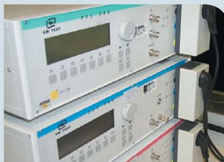
STRUMENTAZIONE PER LA PROVA DI IMMUNITÀ ALLE SCARICHE ELETTROSTATICHE E AI DISTURBI DELLA LINEA
