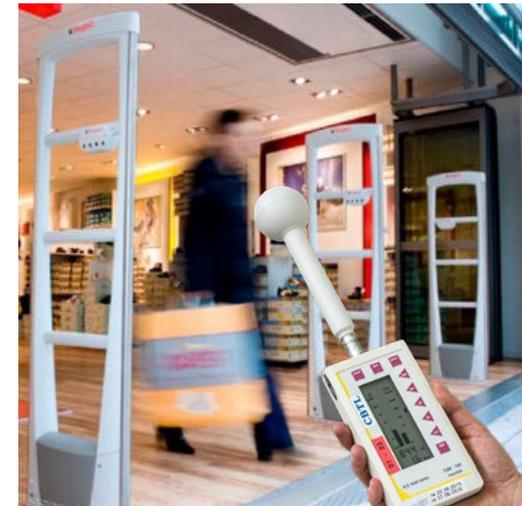
VALUTAZIONE DEL CAMPO MAGNETICO EMESSO DA UN SISTEMA ANTITACCHEGGIO E CALCOLO DEL CAMPO ELETTRICO INDOTTO NEL CORPO UMANO
